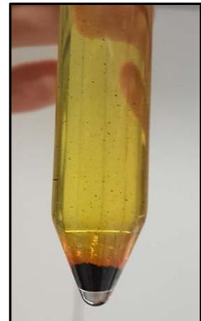
Abb. 16: Unvollständig abgesetzter Rückstand
