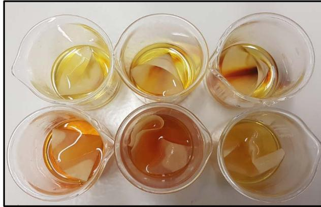
Abb. 11: Lösen des Filtrationsrückstandes in Isopropanol
