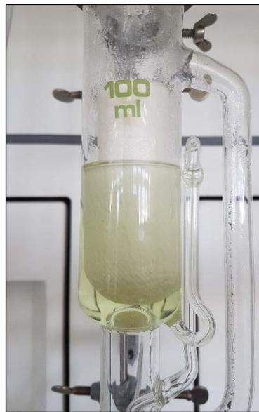
Abb. 20: Soxhlet-Hülse mit Teeprobe
