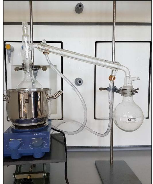
Abb. 27: Destillation des Lösungsmittels Dichlormethan
