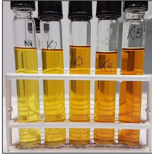
Abb. 8: Unterschiedliche Farbintensitäten der aufbereiteten Stammlösungen zur Kalibration
