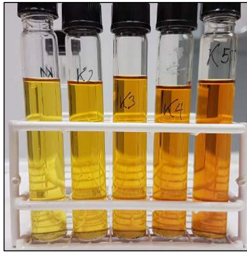
Abb. 8: Unterschiedliche Farbintensitäten der aufbereiteten Stammlösungen zur Kalibration
