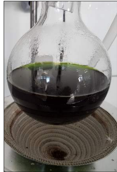
Abb. 21: ethanolischer Teeextrakt nach der 8-stündigen Extraktion
