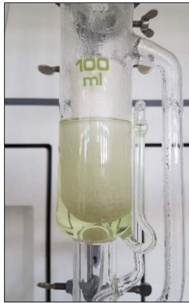
Abb. 20: Soxhlet-Hülse mit Teeprobe
