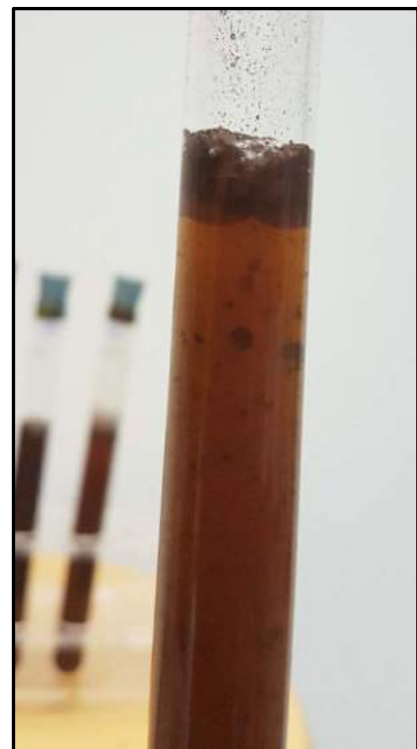
Abb. 18: Suspension mit Koffeinperiodid nach der Zentrifugation des Kaffees
