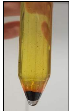
Abb. 16: Unvollständig abgesetzter Rückstand
