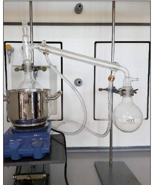
Abb. 27: Destillation des Lösungsmittels Dichlormethan
