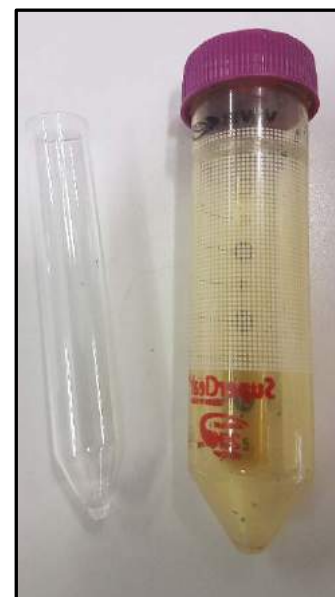
Abb. 14: Zentrifugengläser mit 10 und 50 mL Fassungsvermögen
