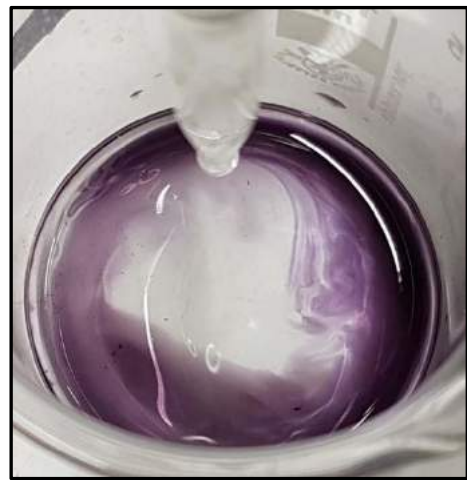
Abb. 6: Entfärbung des Indikators am Umschlagspunkt
