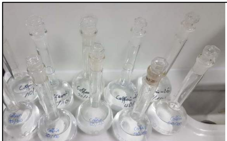
Abb. 4: Maßlösungen mit bekannten Koffeinkonzentrationen ( c = 100\text{--}500\text{ mg/L} )
