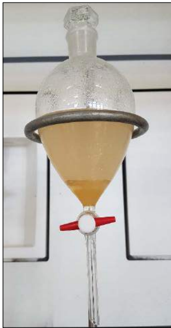
Abb. 25: Ausschütteln mit Dichlormethan
