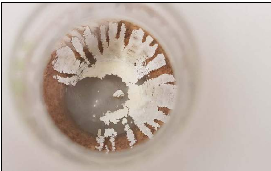
Abb. 28: Erhaltenes Koffein nach Entfernen des Lösungsmittels
