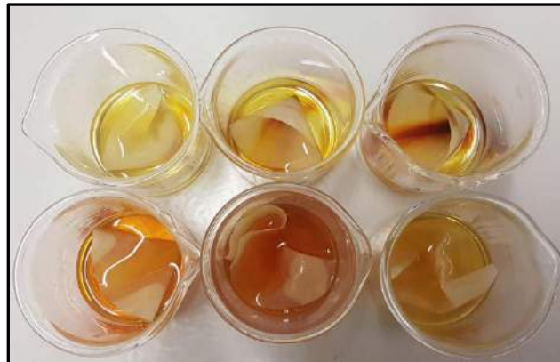
Abb. 11: Lösen des Filtrationsrückstandes in Isopropanol
